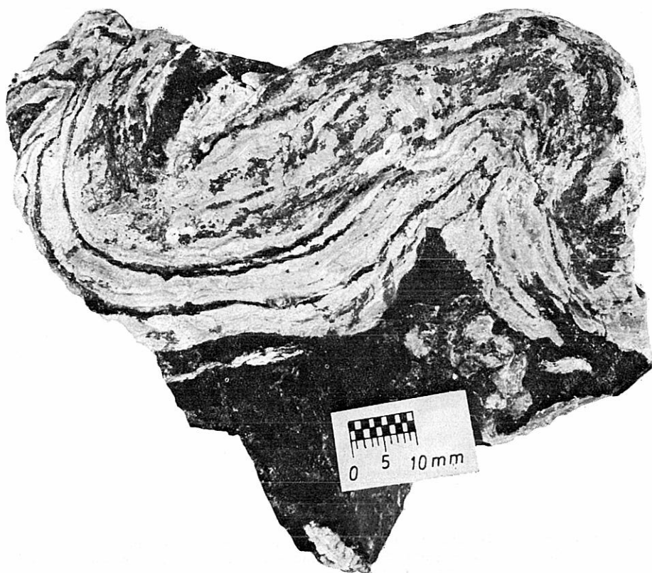
Abb. 1: Rabenstein. Probe aus verfalteter Wechselfolge von schwach metamorphen Tonschiefer- und Erzlagen (vorwiegend Zinkblende; schwarz). Letztere lassen Einpressung in Faltenkerne erkennen. Stellenweise treten Anflüge von sekundärem Pyrit (dunkelgrau bis schwarz) auf.
