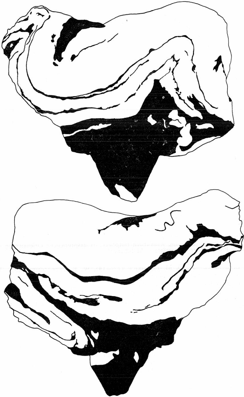
Abb. 3: Rabenstein. Skizze zu Abb. 1 und 2. Die konkordanten Erzlagen dieser verfalteten Wechselfolge sind schwarz ausgezogen, die Tonschieferlagen sowie die sekundären Pyrit-Anflüge dagegen weiß belassen.
