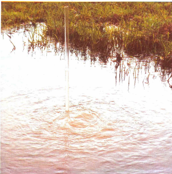
Abb. 7: Aufsprudelndes Wasser an der Quelle Q2 als Anzeichen artesisch gespannter Grundwasserhältnisse. Die Steighöhe des Wassers innerhalb des in den Untergrund eingelassenen Rohres gibt das Niveau des Druckwasserspiegels an (ca. 20 cm über Quellwasserspiegel).
