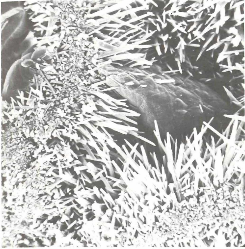
Abb. 7: Bei der Zementation der internen Komponenten Hohlräume mit Hoch-Mg-Kalzit bleibt der nadelige Aragonit der Halimeda-Wandung unverändert. REM-Foto 2-4482; Probe Rarotonga 4; Vergrößerung 2100x.
