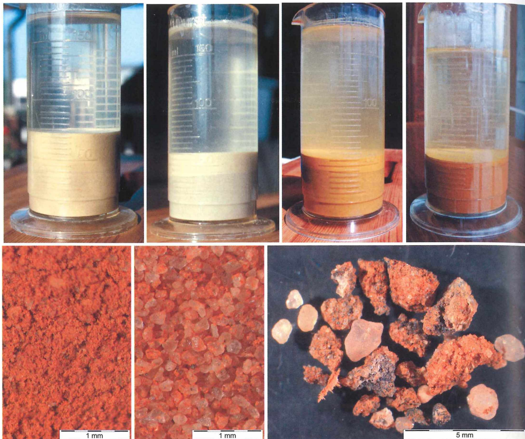
Abb. 36 (oben): Absetzversuche mit verschiedenfarbigen Sandsteinarten; v.l.n.r. 12 weiß, 3E weiß, 3E gelb, Eg braun; Abb. 37 (unten): Die Komponenten des dunkelbraunen Sandsteins unter dem Mikroskop (Eg)
