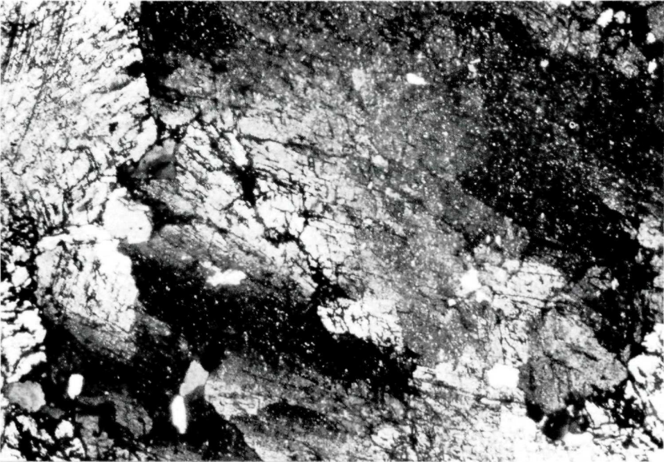
Abb. 7 Die undulöse Auslöschung der Sideritkörner im Dünnschliff. Nicols II. Natürliche Größe des Ausschnittes 2,6 \times 1,8 mm.
