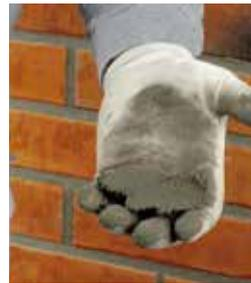
Die Konsistenzprüfung mittels Handdrucktest gibt Aufschluss darüber, ob der Fugenmörtel richtig eingestellt ist. Die Mörtelprobe darf nicht zerfallen und es darf kein Wasser herausgedrückt werden.
