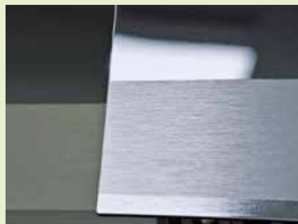
Bürststruktur auf verchromten Kunststoffbauteilen von BIA
