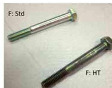
Abbildung 8: Fluoridbasierte Passivierungsschicht getrocknet bei 55 °C/10 min und bei 215 °C/6h
