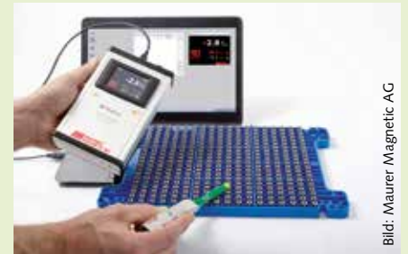
Die Software „Field Indicator“ unterstützt den Nutzer bei der Arbeit mit dem M-Test LL von Maurer Magnetic.
