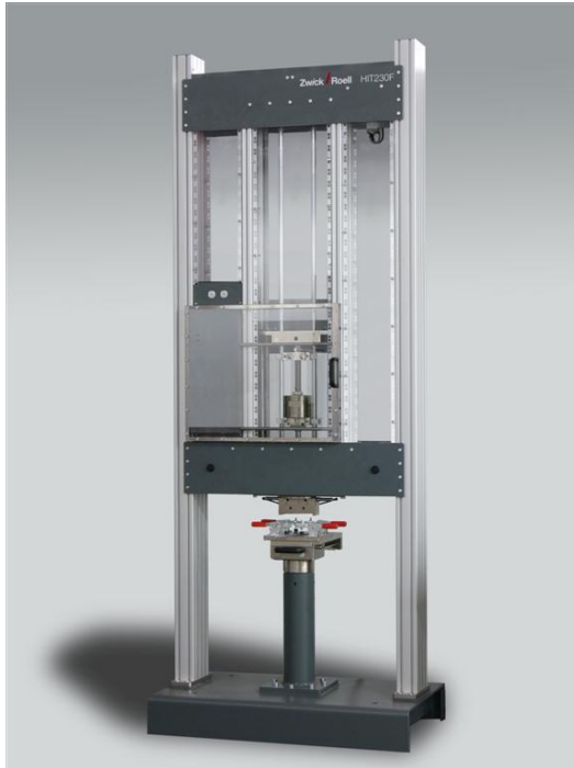
Im instrumentierten Fallwerk HIT 230F wird der Probekörper unter festgelegten Bedingungen vorgeschädigt.
