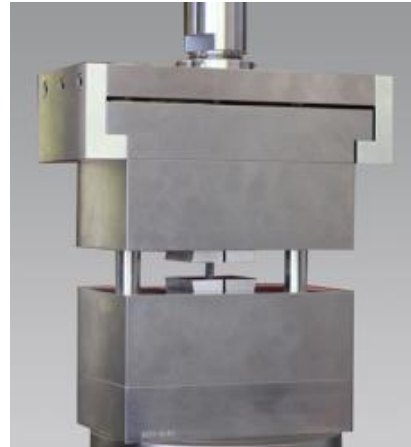
DIN 65375 und prEN 2850 bieten modifizierte Celanese - Einrichtungen an, die mit Flachkeilen das Problem der Probendicke lösen (links). Das IITRI entwickelte eine ähnlich wirkende Einrichtung, die auch das Torsionsproblem löste (rechts)
