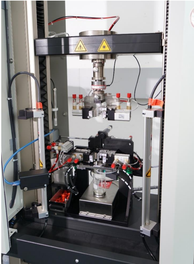
Prüfung an Autoinjektoren (ISO 11608-5)
