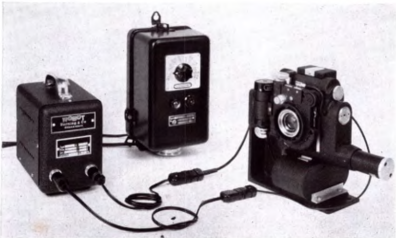
Vollelektrische fotografische Registrieranlage mit Netzanschlußgerät und elektronischem Zeitschaltwerk, betriebsfertig
